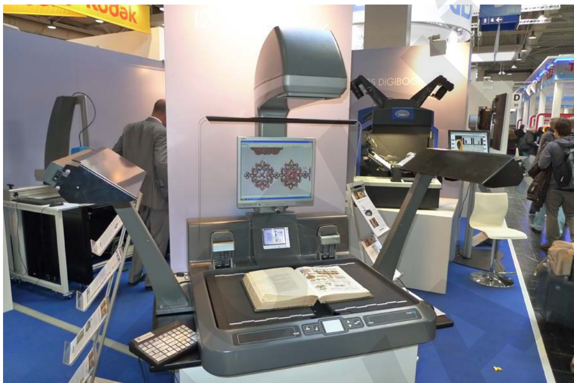
Obr. 8. Skener využívající technologie rotujícího barevného kroužku. Technologická limitace (posun barevných spekter) je vyřešena v tomto případě pomocí automatického algoritmu již v procesu samotné digitalizace.
