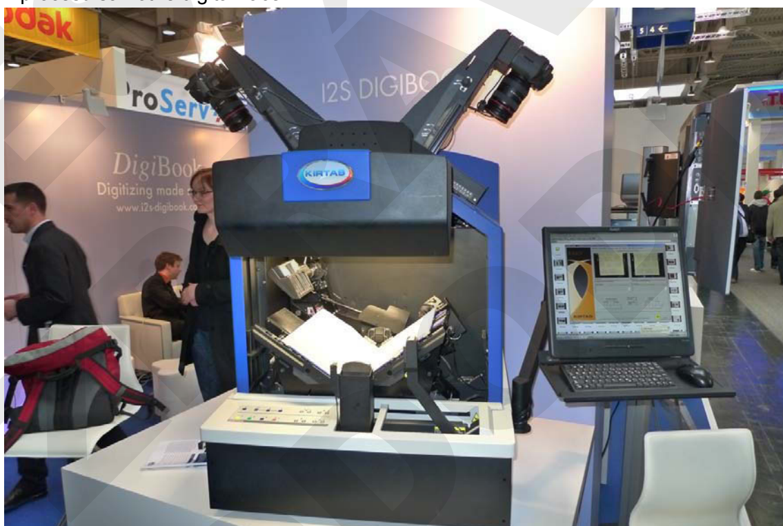
Obr. 7. Dvoustránkový produkční skener KABIS II, KIRTAS (USA), který nedociluje tak vysoké kvality jako předešlý skener, vyznačuje se vyšší produkční rychlostí.
