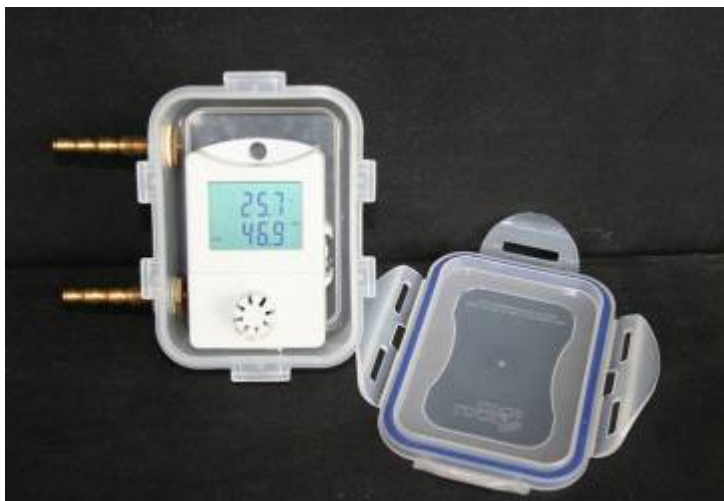
Obrázek 3. Umístění vlhkostního čidla v průtočném boxu.
