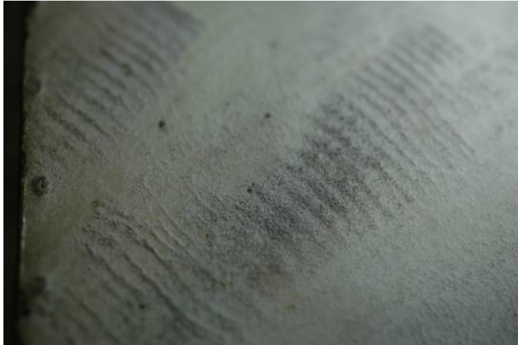
XIV A 13 Vyšehradský kodex, NK ČR. Detail stop po odsakování nože při broušení pergamene dochovaný na okraji pergamenového folia.
