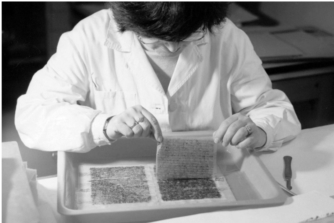
Obrázek 2 Jan Amos Komenský: Labyrint světa a ráj srdce (1623), ukázka štěpení papíru [Archiv OR, svitkový film 6 x 6 cm, 1988]
