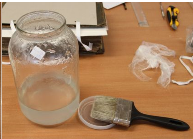
Obrázek 4 Zásobník Klucelu G v etanolu s nanášecím štětcem
