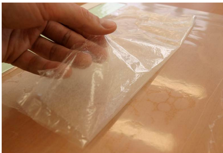
Obrázek 4 Sejmutí AJF z plastové podložky
