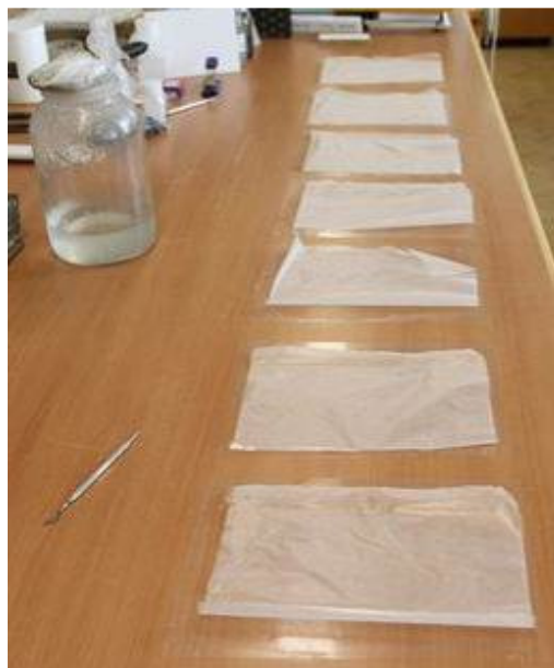
Obrázek 13 Sejmuté klucel-japanové fólie na pracovním stole
