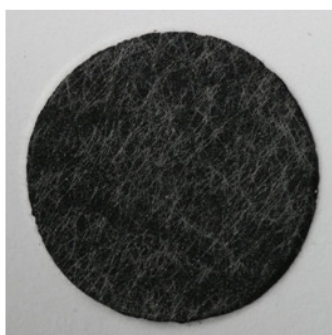
Klucel G v Herco, 3x vrstva (aktivace: 50 % etanol)
