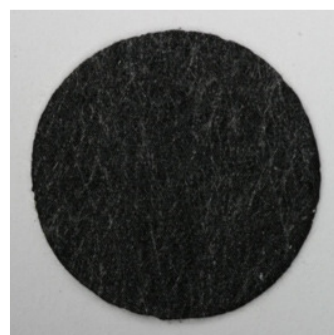
Klucel G v Herco, 5x vrstva (aktivace: 75 % etanol)
