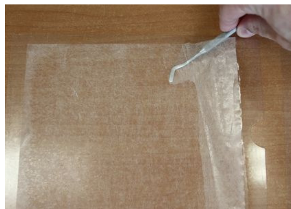
Obrázek 9 „Zubátkem“ uvolníme fólii nejlépe ze dvou stran pro bezpečné sejmutí z podložky
