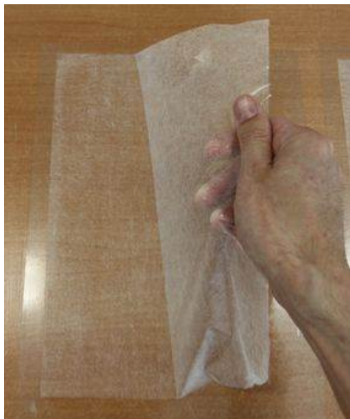
Obrázek 10 Snímání fólie z podložky
