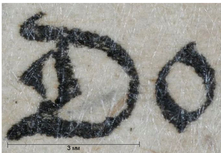
Obrázek 8 AJF s Klucelem G v etanolu nalepená na historickém papírovém podkladě, lepeno 50 % roztokem etanolu, detail
