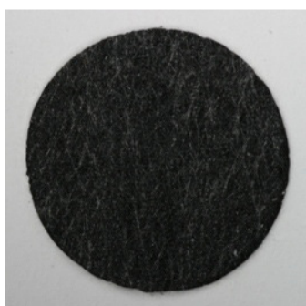
Klucel G v Herco, 5x vrstva (aktivace: 50 % etanol)
