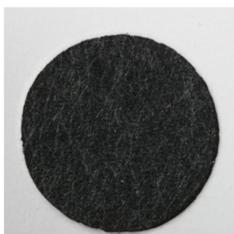
Tylosa MH 4000 v Herco, 3x (aktivace: 50 % etanol)
