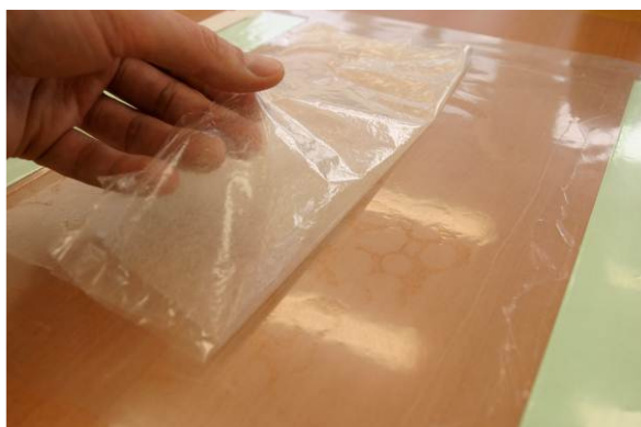
Obrázek 10 Příprava skeletizačních folií z japonského papíru a Klucelu G
