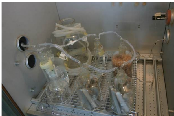
Obrázek 4 Část aparatury s ovlhčováním vodou 80 °C a silikonovou hadicí vně klimatizační komory
