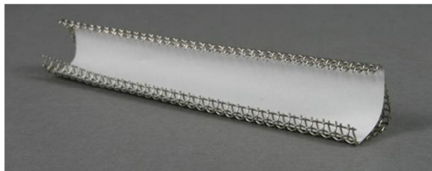
Obrázek 2 Kontejner z nerezové síťoviny s jedním vzorkem
