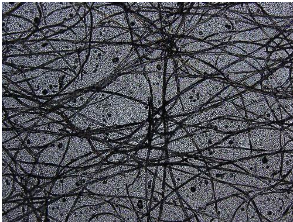
Obr.č. 1 – Folie K1 před stárnutím, zvětšení 40x
