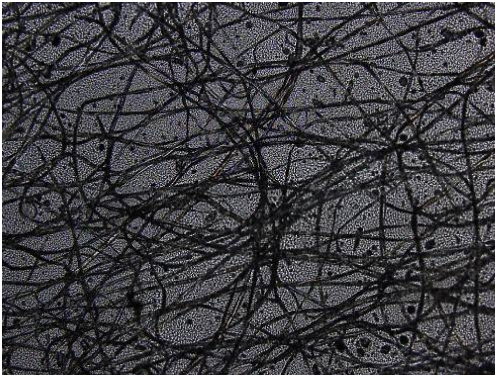
Obr.č.2 – Folie K1 po stárnutí 8 dnů, zvětšení 40x
