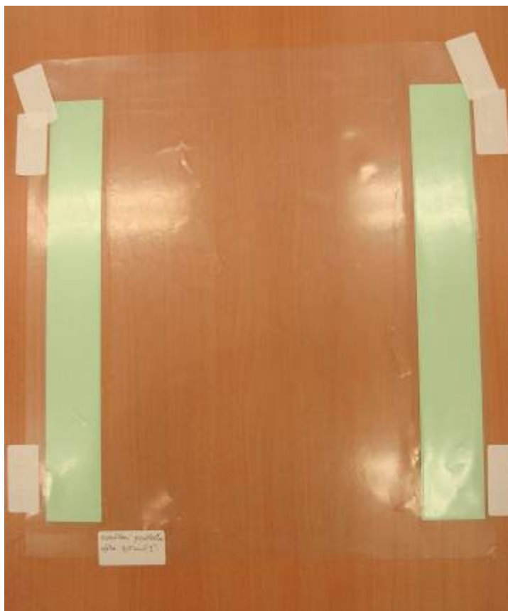
Obr.1 /Nanášecí plastová podložka s vodícími bariérami z papírové lepenky, zde o výšce 0,55mm.
