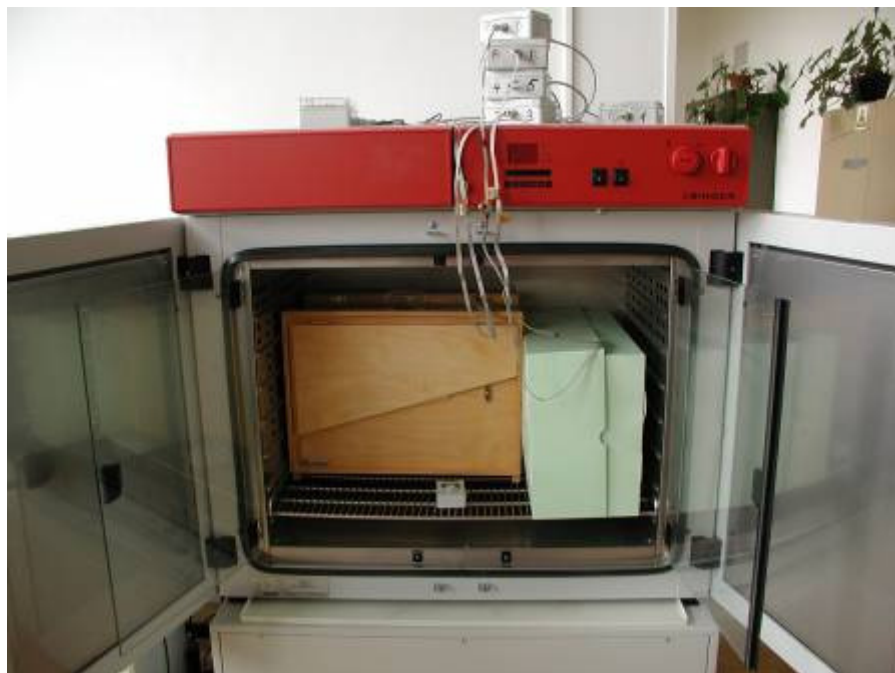
Obr.č.2 – Uložení krabic v klimatizační komoře
