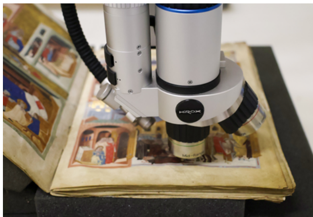
Průzkum barevné vrstvy digitálním mikroskopem.
